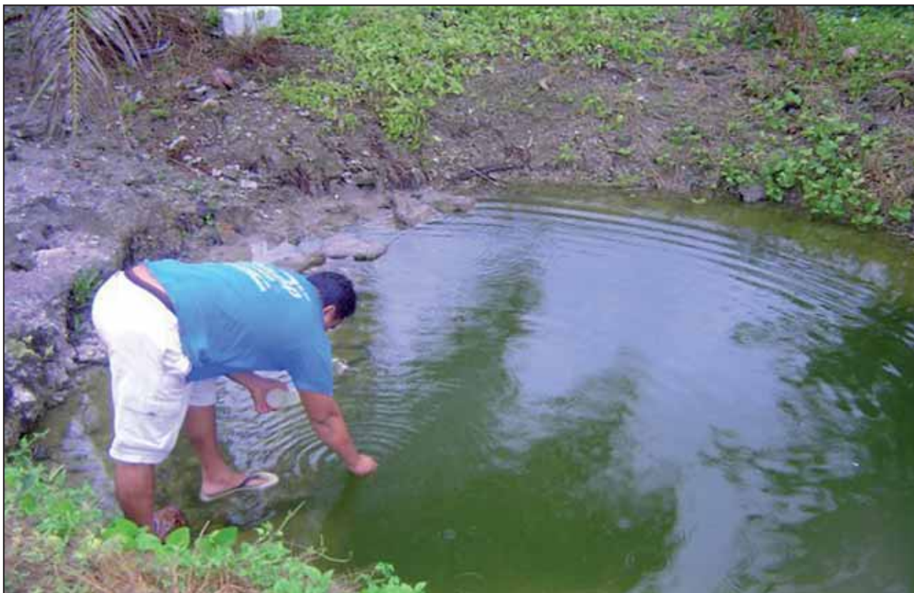
L'acqua si trova ad un metro di profondità. Si tratta dell'acqua piovana che, essendo dolce ha una densità differente dell'acqua salata del mare. Così si crea una «lente» utilizzabile per l'agricoltura. Nella foto facciamo dei prelievi che saranno analizzati per un laboratorio in Nuova Zelanda. Cerchiamo eventuali tracce di prodotti chimici. Il Ph dell'acqua è analizzata all'istante. Se l'acqua è troppo basica aggiungiamo aceto per correggerla.
